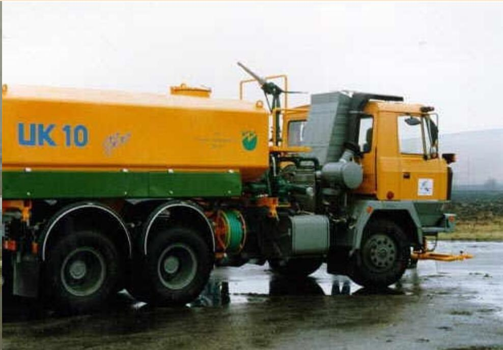
При дезактивации, в зависимости от обстановки и объекта дезактивации, используются различные методы. Участки территории, имеющие твёрдое покрытие дезактивируются с помощью смыивания радиоактивных веществ (пыли) под большим давлением с помощью поливочных и пожарных машин.
