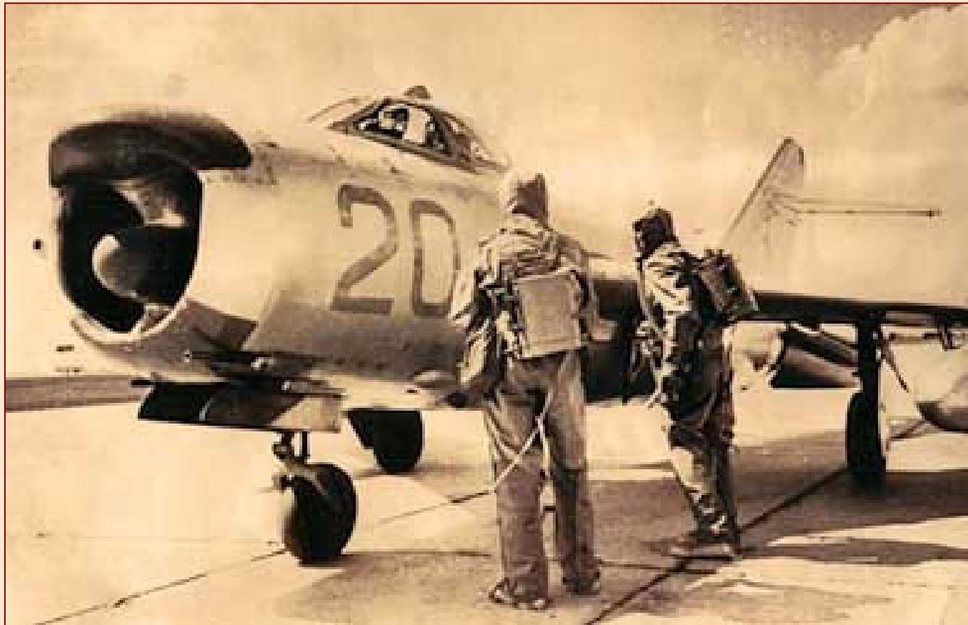
Принцип действия и РКДП, и прибора ДКВ одинаков и заключается в подаче дезактивирующего раствора из резервуара давлением сжатого воздуха через жидкостные шланги к брандспойтам и распределении на обрабатываемой поверхности с помощью щеток.
